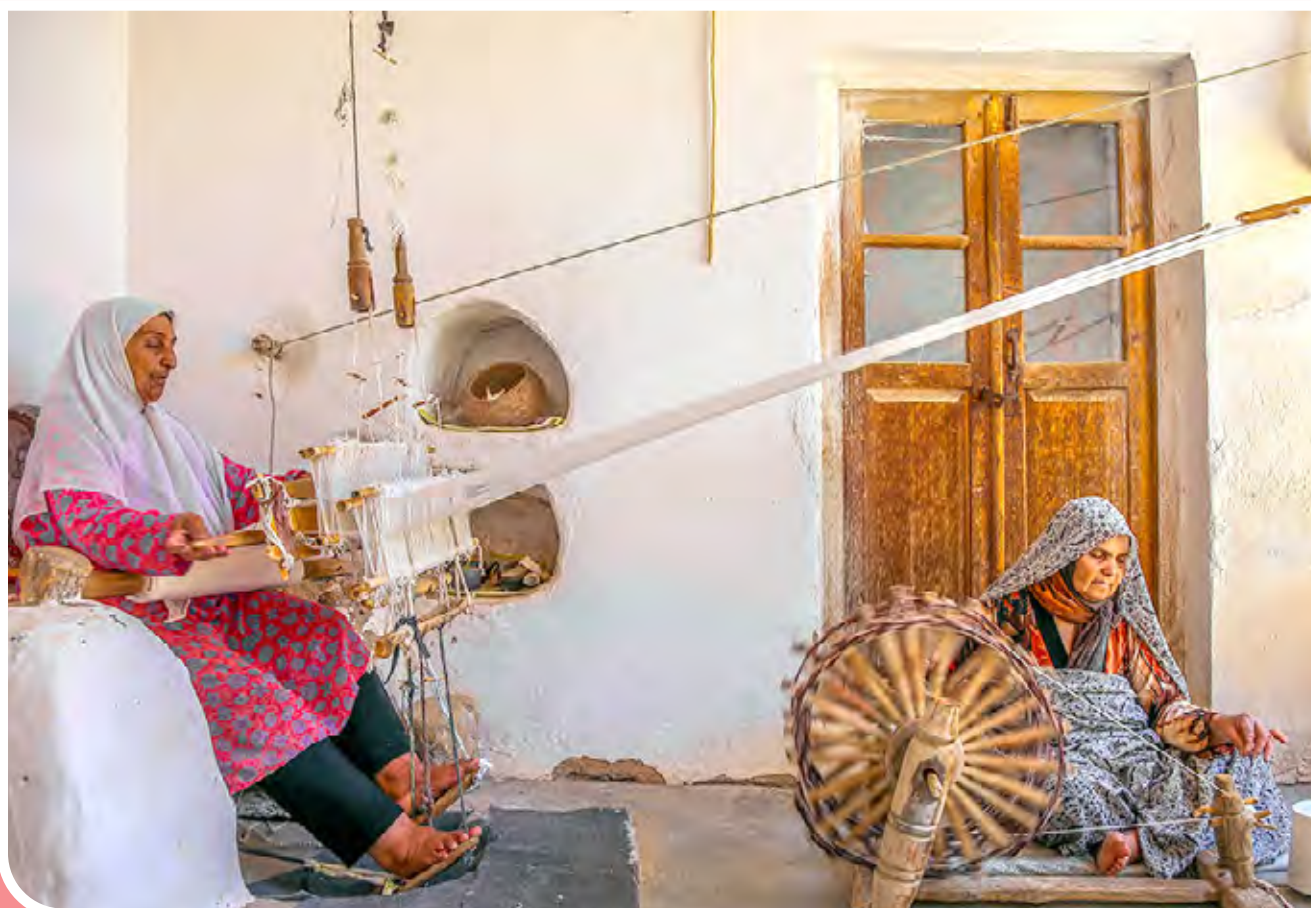
حوله بافی (که توفایی یا تون بافی نیز نامیده می‌شود) نوعی فرآورده نساجی سنتی است که به کمک دستگاه بافندگی چهار وردی تولید می‌شود. این محصول و دست‌بافته در روستای خراشاد واقع در استان خراسان جنوبی ریشه‌های کهن دارد و نقش مهمی در صنعت و جامعه آن ایفا می‌کند. / عکس از پیمان حمیدی‌پور
